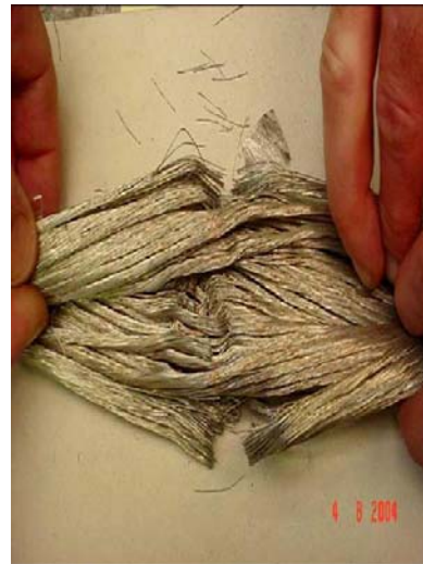
Σχήμα 2: Δοκιμή ενός καλωδίου H07RN-F 1X300mm 2 σε στρεπτική φόρτιση μεγάλης διάρκειας. Σπασμένα συρματίδια σε ποσοστό μεγαλύτερο του 70%. Εντελώς σπασμένος αγωγός μετά από μόλις 2.000 περιστροφές.
