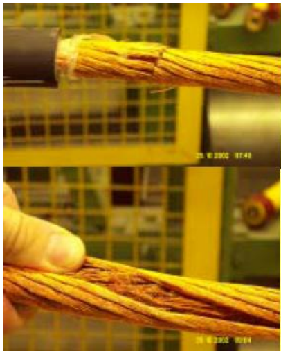
Σχήμα 2: Δοκιμή ενός καλωδίου H07RN-F 1X300mm 2 σε στρεπτική φόρτιση μεγάλης διάρκειας. Σπασμένα συρματίδια σε ποσοστό μεγαλύτερο του 70%. Εντελώς σπασμένος αγωγός μετά από μόλις 2.000 περιστροφές.
