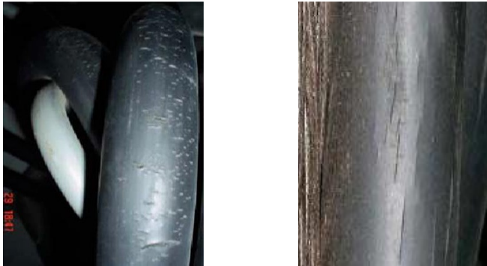
Σχήμα 7: Θραύση στο μανδύα ανταγωνιστικών καλωδίων μετά από χρήση 18 μηνών σε ανεμογεννήτριες
